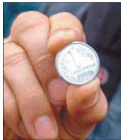
Процесс изготовления такой монеты прост: в пресс помещается клише, с которого во время удара рисунок переносится на металлическую болванку из латуни, меди или алюминия. На выходе получается сувенир, сделанный своими руками. Организаторы показали несколько вариантов монет и предложили попробовать изготовить их участникам мероприятия и просто случайным зрителям – прохожим.
