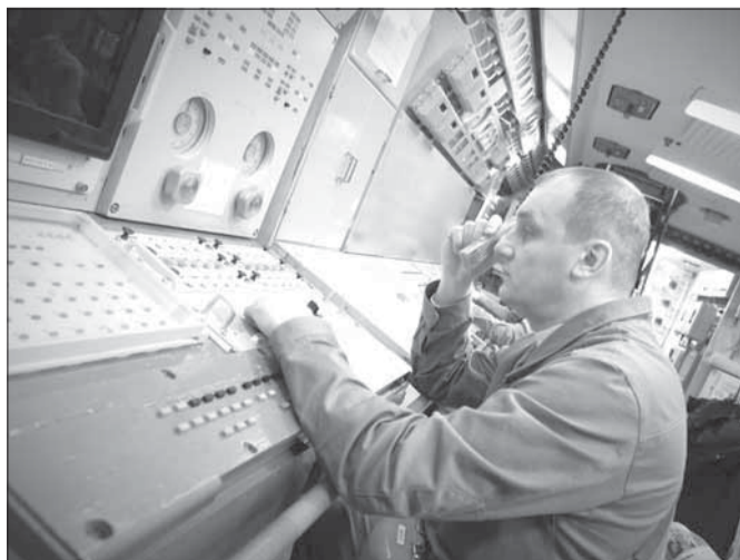
С центрального поста управляют практически всеми системами подлодки, включая систему запуска ракет.
